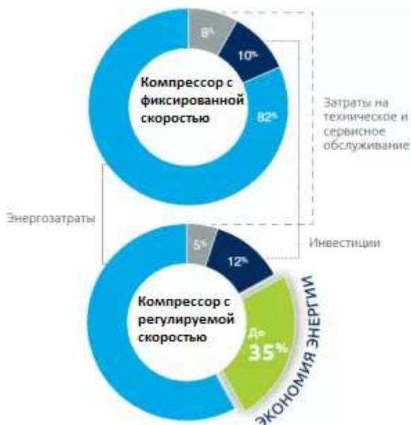
Компрессоры с технологией VS (с частотным регулированием вращения двигателя) позволяют гибко подстраивать производительность компрессора исходя из текущей потребности в сжатом воздухе.
