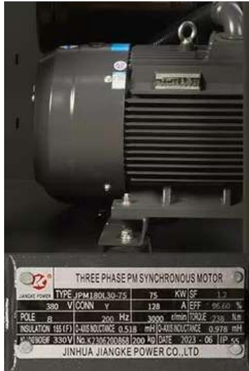
Надежный электродвигатель известного качеством производителя Jiangtian Jiangke Power с классом энергоэффективности IE3 и классами защиты IP55 предназначен для круглосуточного использования на предприятиях с разной степенью запыленности, имеет низкий уровень шума и вибрации.
