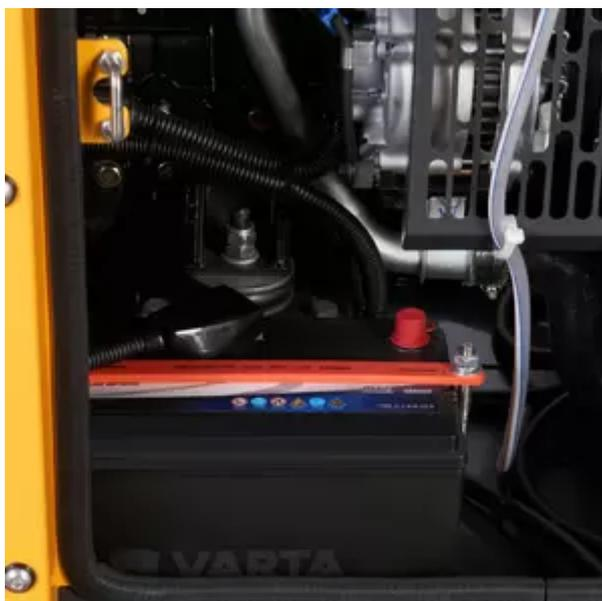
Зимний пакет в стандартной комплектации. Компрессор оснащен свечами предпускового подогрева и аккумулятором повышенной емкости, что обеспечивает уверенный пуск при температуре до  $-20^{\circ}\text{C}$ .
