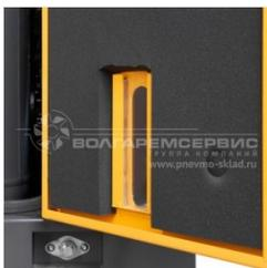
Качественная шумоизоляция. Помимо тихого двигателя с глушителем и металлического защитного кожуха компрессорная станция оснащена звукопоглощающими панелями из качественного вспененного материала. В совокупности это существенно снижает уровень акустических нагрузок, способствует комфортной работе в непосредственной близости от оборудования;
